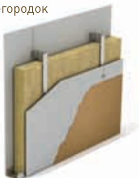
Система межкомнатных перегородок
